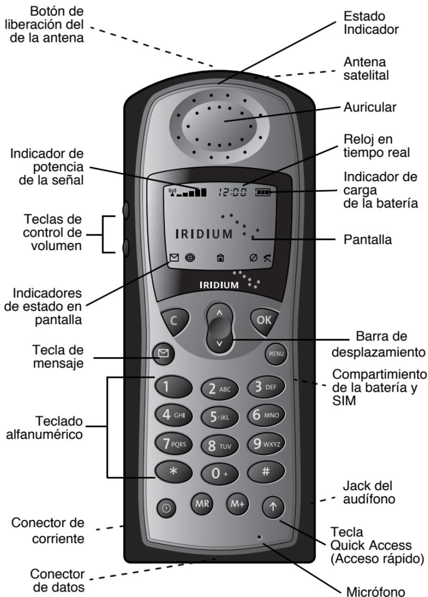
**Nota:** El teléfono se muestra con la antena en posición retraída.
