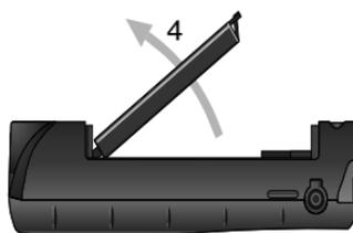
**Inserte la batería,** primero el extremo inferior, en el compartimiento y luego presione la batería hacia abajo hasta que haga clic al estar en su lugar.
