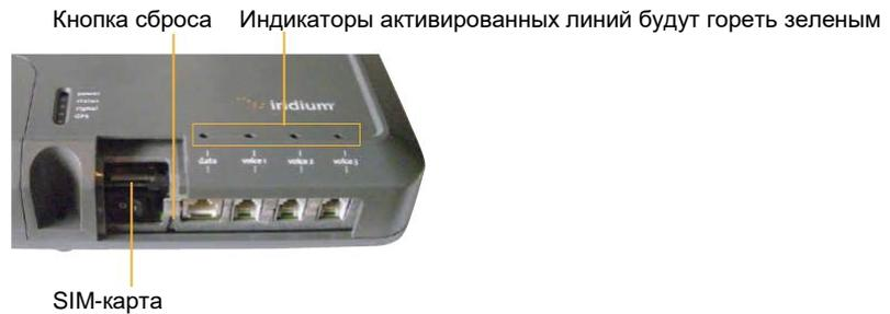
Порты для подключения линии передачи данных и телефонных трубок находятся в днище блока BDE. Предусмотрен один порт для кабеля передачи данных и три порта для телефонов. Порт данных обозначен как «data», а телефонные порты — «Voice 1», «Voice 2» и «Voice 3».
