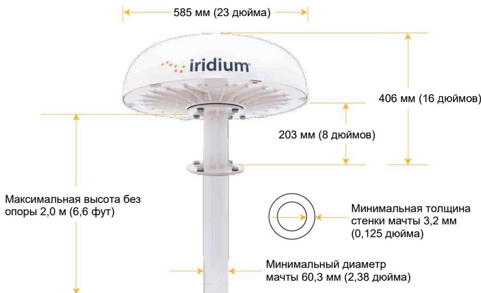
Блок ADE поставляется с алюминиевой переходной подставкой, используемой для его крепления к мачте. В подставке имеется отверстие, через которое можно продеть круглый разъем кабеля для подключения к блоку ADE. Чертеж подставки прилагается. При изготовлении мачты учитывайте расположение отверстий под болты. Более подробную информацию вы найдете в Приложении Е.
