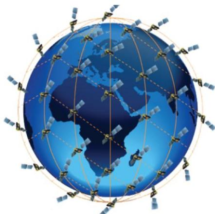
Голосовой вызов или цифровые данные принимаются спутником, ближайшим к текущему местоположению устройства Iridium Pilot, в любом месте на Земном шаре. Трафик направляется по спутниковой сети на наземную станцию сопряжения на Аляске, а затем по наземным сетям к шлюзу в Аризоне. На шлюзе трафик преобразуется обратно в цифровой сигнал протокола IP или голосовой вызов, в зависимости от типа вызова, и доставляется в IP-облако или телефонную сеть общего пользования (PSTN).
